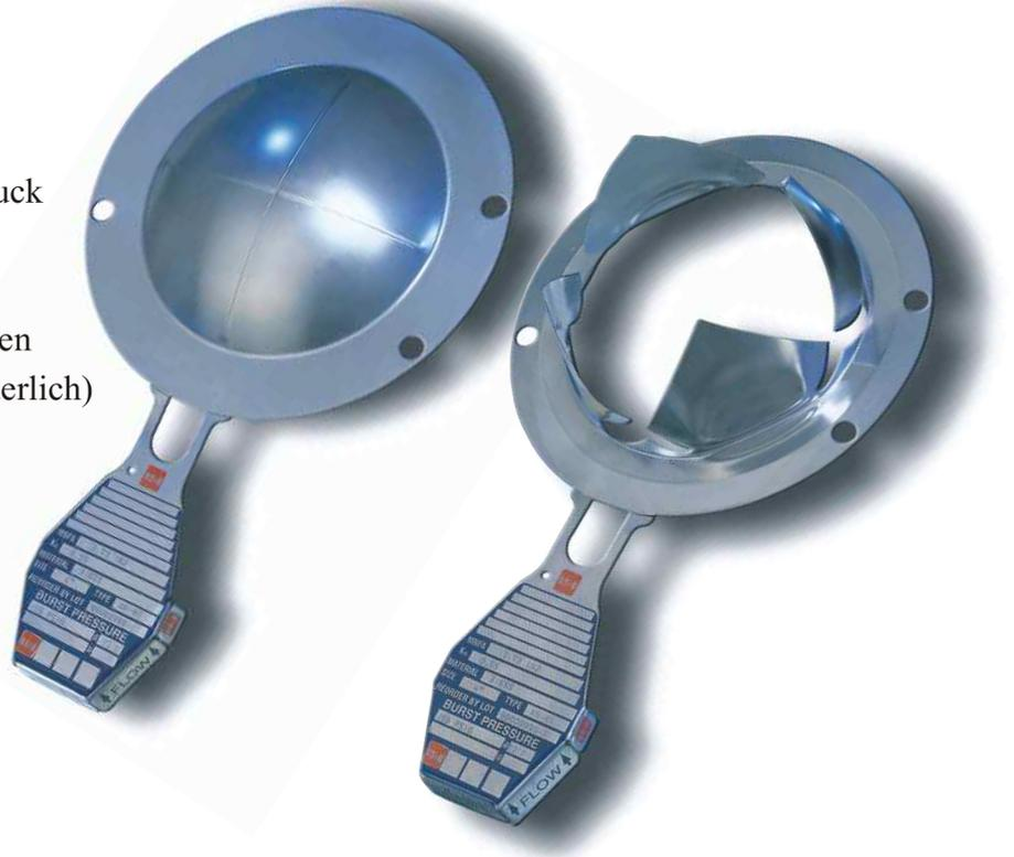
Das besondere bei der Herstellung der XN-85™-Scheibe ist, dass erst nach der Vorwölbung die Kerbung erfolgt. Dadurch wird die Kerbspannung verringert. Dies optimiert die Lebensdauer bei hoher Dauer- und Druckwechselbelastung bei 85% des Nennberstdruckes oder 90% des Mindestberstdruckes. Bitte sprechen Sie mit uns über Ihre Anwendungsanforderungen.
